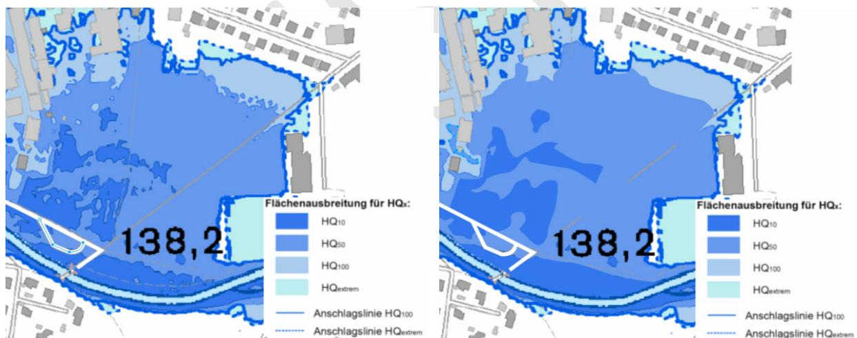
Abbildung 7: links: Flächenausbreitung unkorrigiert; rechts: Flächenausbreitung korrigiert
